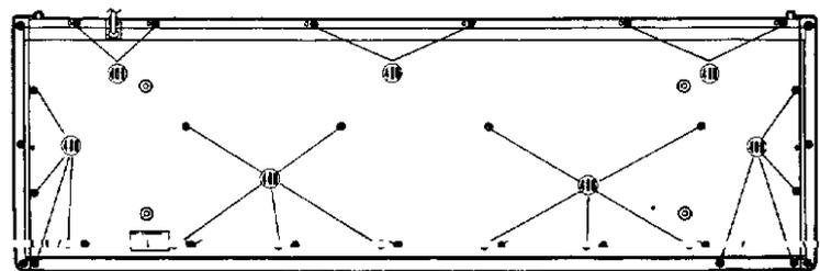
④ : 4.0 × 8 Bonding Tapping Screw (ボンディングタッピングネジ)
